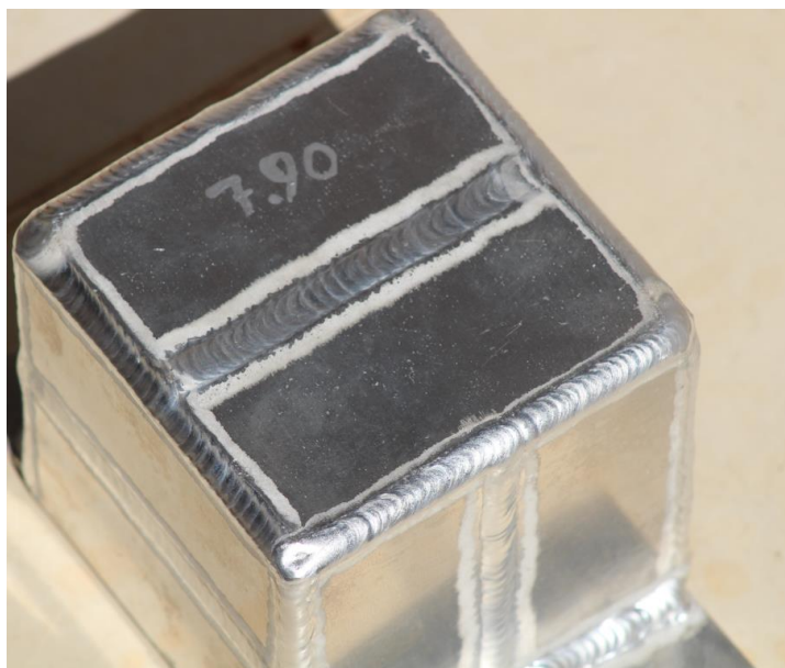
Figura 3: Vista superior de estrutura em alumínio naval 5052H34 soldada pelo processo TIG
