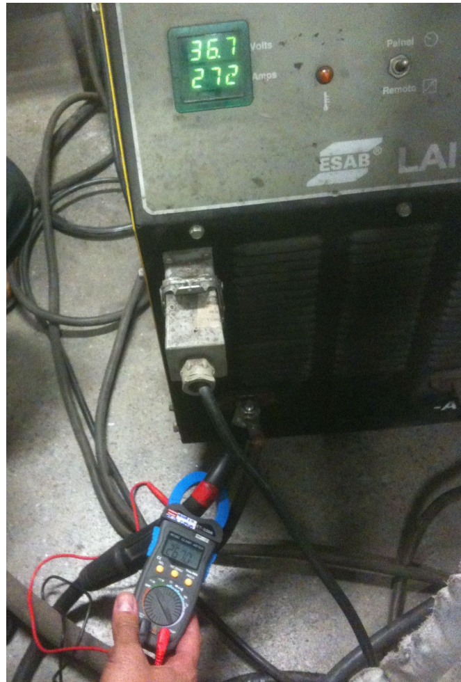
Fig 1- Máquina de solda sendo calibrada
